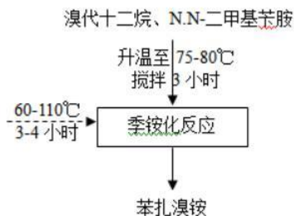
图 4.1-3 苯扎溴铵生产工艺流程及产污位置图
